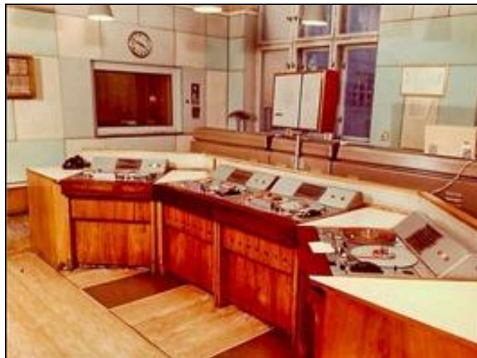
Vysílací pracoviště rozhlasové stanice Praha. Čtyři magnetofony Sander-Jahnsen 100, rychlost 38 cm/sec.
