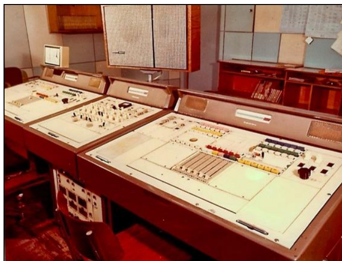
Vysílací pracoviště rozhlasové stanice Praha. Mixážní pult – šest „šavlí“ je pro čtyři magnetofony a dva mikrofony.
